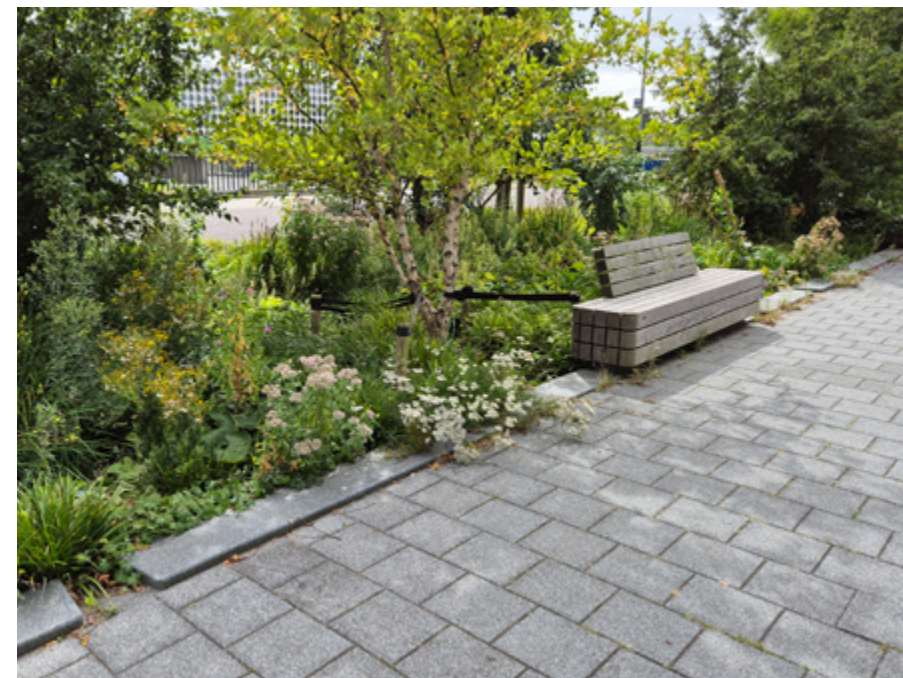
Regentuin in Amsterdam als referentie voor waterbuffering in straten en parken. Foto door Nanda Sluijmsmans
